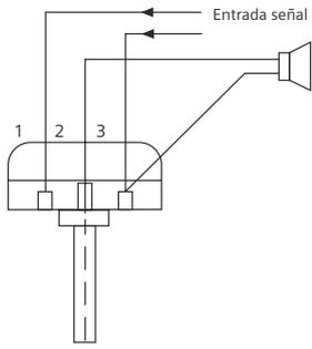
Esquema de conexión mono
