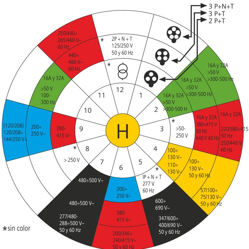
Todas las tomas de corriente están fabricadas en distintos colores, que permiten diferenciar las distintas tensiones y frecuencias fácilmente. Sobre demanda se puede suministrar cualquier posición horaria dentro de la Norma UNE-EN 60309-1/60309-2.
