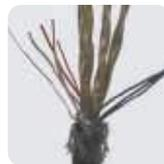
**2.** Recorte los cables a unos 35mm, excepto el cable del blindaje.
