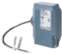
Fuente alimentación tipo JB de 80 mA 5WG1125-4CB23 Tipo: JB 125C23 Para montaje en el interior o anexas a cajas de conexión tipo UL/NEMA mediante conector roscado de 1/2". Tensión de alimentación de 120 V CA 50..60 Hz.
